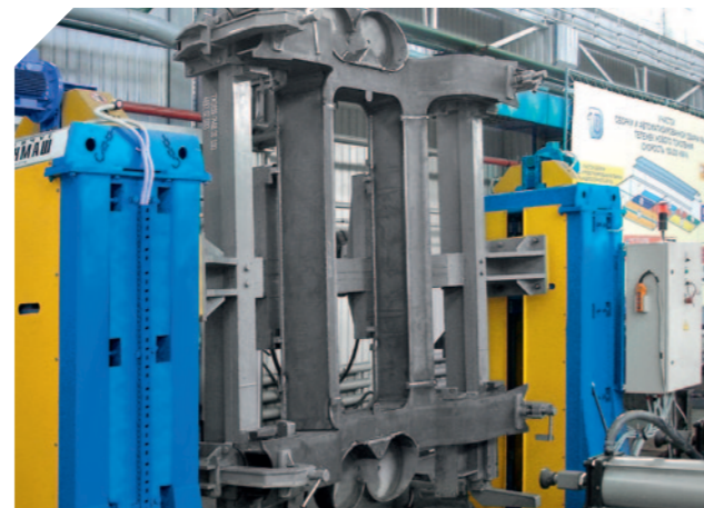
Кантователь с подъемными центрами грузоподъемностью 4 т
