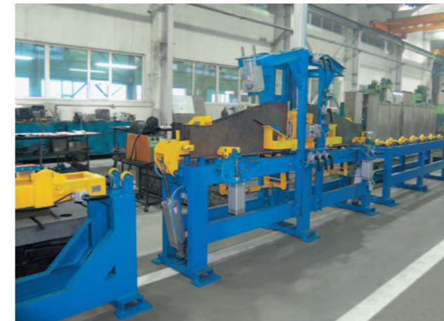
Сборка промежуточных балок грузовых вагонов
