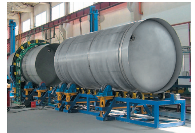
Линия сборки и сварки котла
