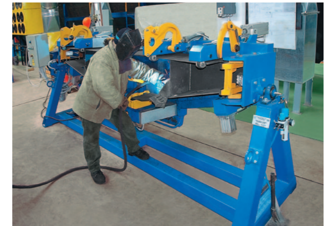
Сборка промежуточных балок грузовых вагонов
