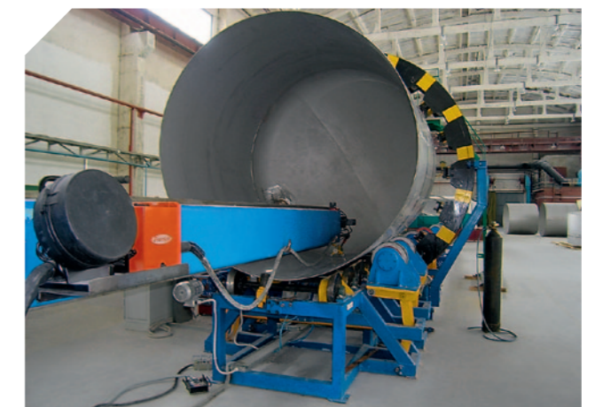
Сварка внутреннего шва
