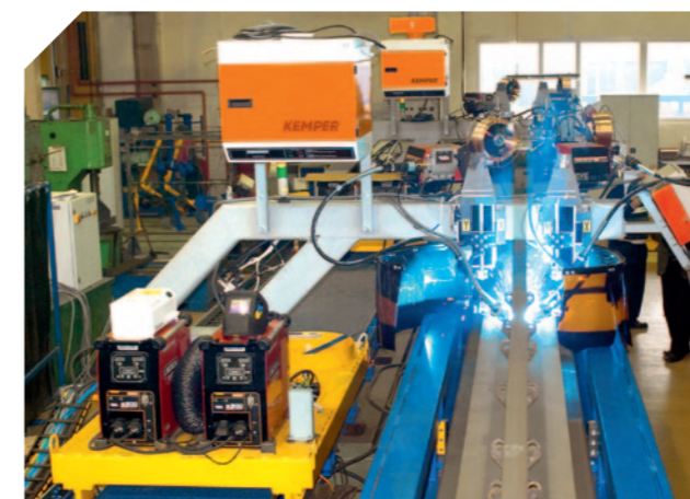
Одновременная сварка двумя горелками
