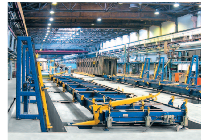
Сборка боковых стен пассажирских вагонов
