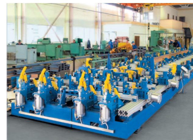
Универсальный стенд сборки рам пассажирских вагонов
