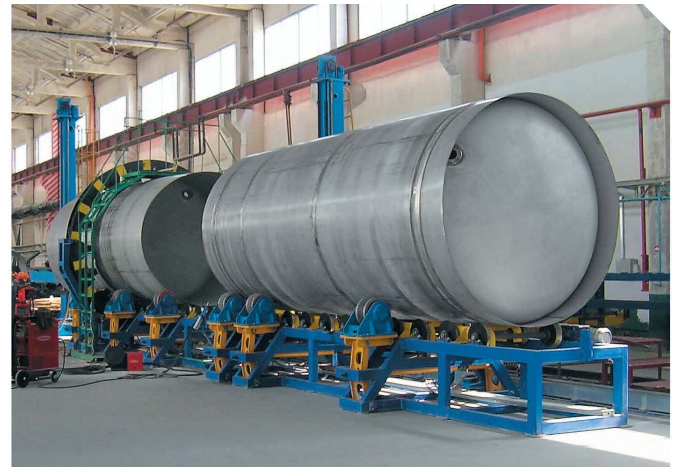
Линия сборки и автоматической сварки котлов
