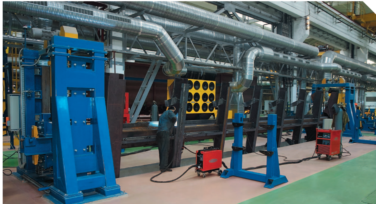
Кантователь с подъемными центрами грузоподъемностью 15 т
