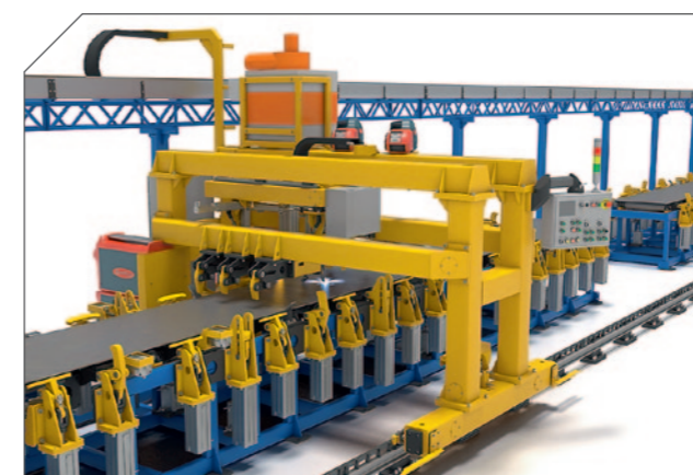
Портал автоматической прихватки швеллеров
