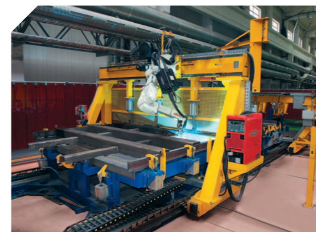
Роботизированная сварка стоек торцевой стены
