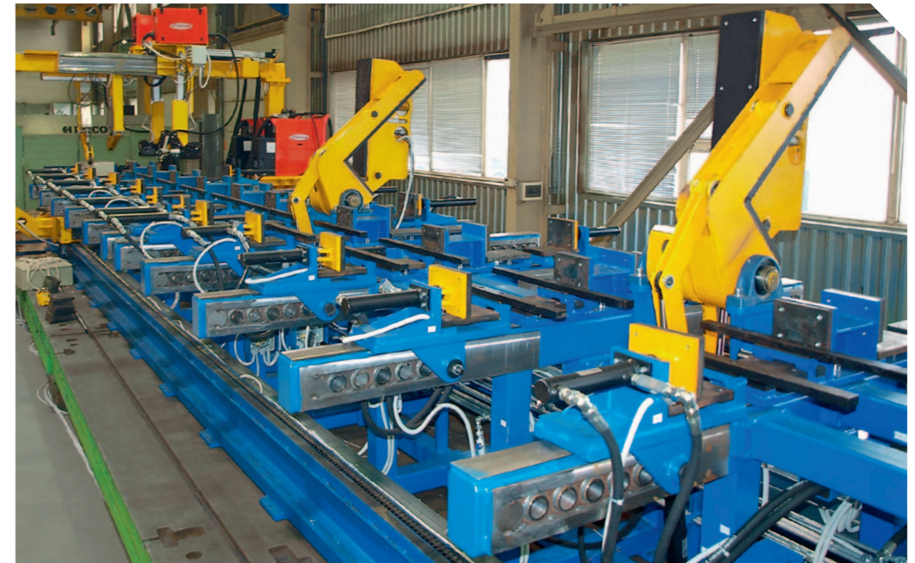
Универсальная линия сборки и автоматической сварки лонжеронов
